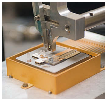
Bild 1: Vormontierter Laser (links) und aktive Ausrichtung der optischen Komponenten mit \mu\text{m} -Präzision (rechts) vor der permanenten Fixierung mittels Hochtemperatur-Aushärten
